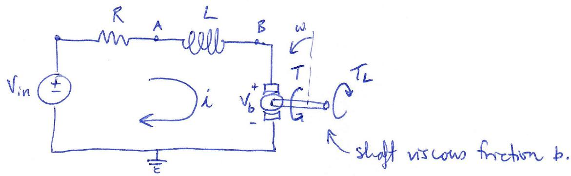
Electrical part:  $V_{in} \xrightarrow[i]{R} V_A$        $V_{in} - V_A = iR$
